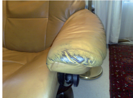
Svettskada på armstöd
